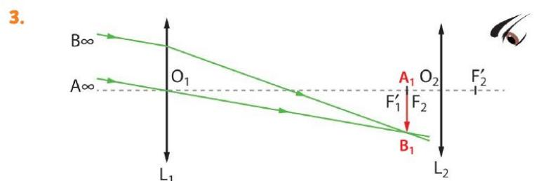
3 Tous les faisceaux émergents de l'objectif  $L_1$  se croisent en  $B_1$ . Le point  $A_1$  est placé sur l'axe optique de façon à obtenir l'image intermédiaire  $A_1B_1$  perpendiculaire à l'axe optique.
