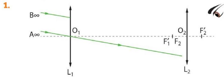
1 Il faut s'appuyer sur des faisceaux dont on est capable de connaître la déviation à travers la lentille. L'objet étant à l'infini, les faisceaux incidents sont tous parallèles entre eux. Le plus simple à tracer est le faisceau passant par le centre optique  $O_1$  puisqu'il n'est pas dévié.
