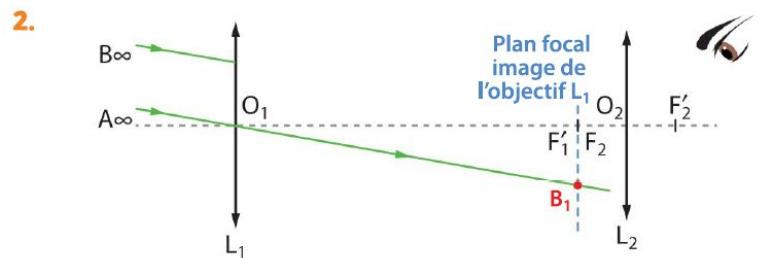
2 Puisque les faisceaux incidents sont parallèles entre eux, ils vont se croiser dans le plan focal image de l'objectif  $L_1$  : au niveau du foyer secondaire image  $B_1$ .
