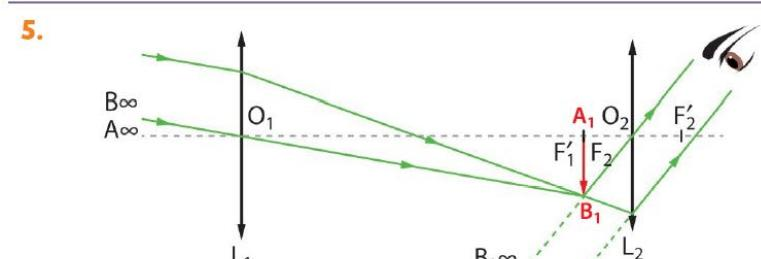
5 Dernière étape, on prolonge le rayon d'étude jusqu'à l'oculaire et on trace sa partie émergente. L'image intermédiaire se trouvant dans le plan focal objet de l'oculaire, tous les faisceaux émergents sont parallèles entre eux : l'image définitive  $A_2B_2$  est à l'infini (c'est bien le but de la lunette afocale !).
